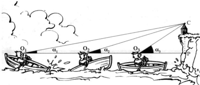
\* **Mesure** les amplitudes successives des angles de visée  $\alpha_1$ ,  $\alpha_2$  et  $\alpha_3$  :
