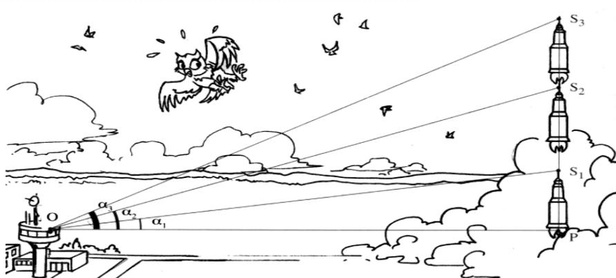
\* **Mesure** les amplitudes successives des angles de visée  $\alpha_1$ ,  $\alpha_2$  et  $\alpha_3$  :
