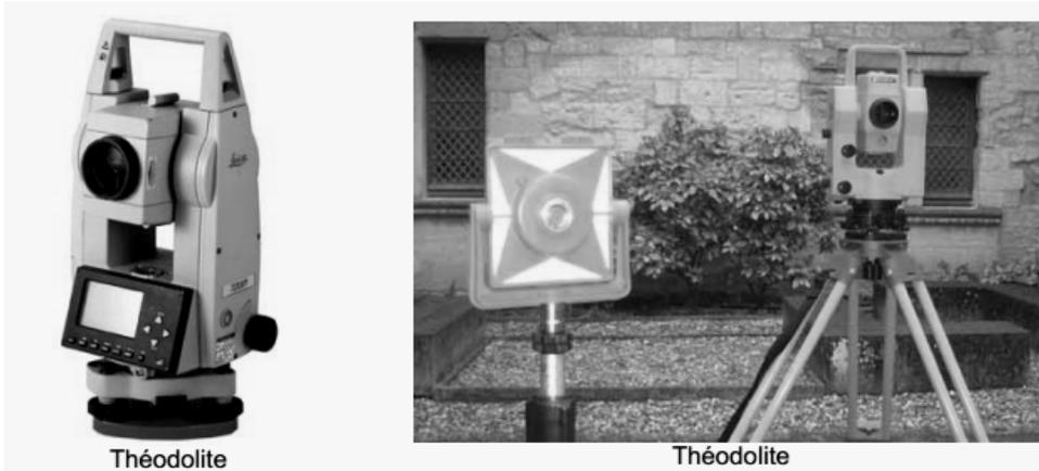
Le théodolite est un appareil permettant de mesurer des angles. Il est principalement utilisé par les géomètres et les topographes qui font souvent des mesures difficiles sur le terrain.
