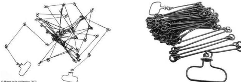
Une **chaîne d'arpenteur** est un instrument de mesure destiné aux travaux de prise de distances sur le terrain, souvent réalisés par un géomètre.
